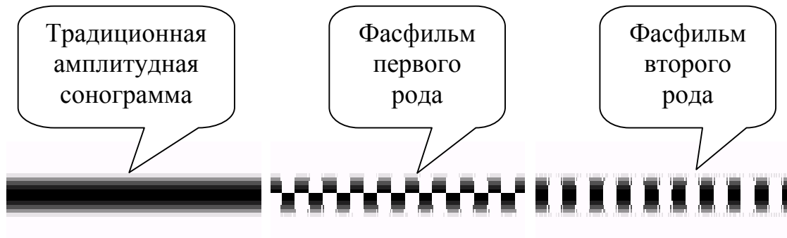
Рис. 5. Визуализация следа частотно модулированной гармоник (колебание частоты равно 0,001%).
