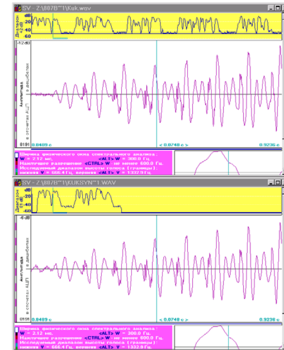
Рис. 2. Осциллограмма фрагмента исходного речевого сигнала (вверху) и синтезированного по всему множеству следов (снизу).
