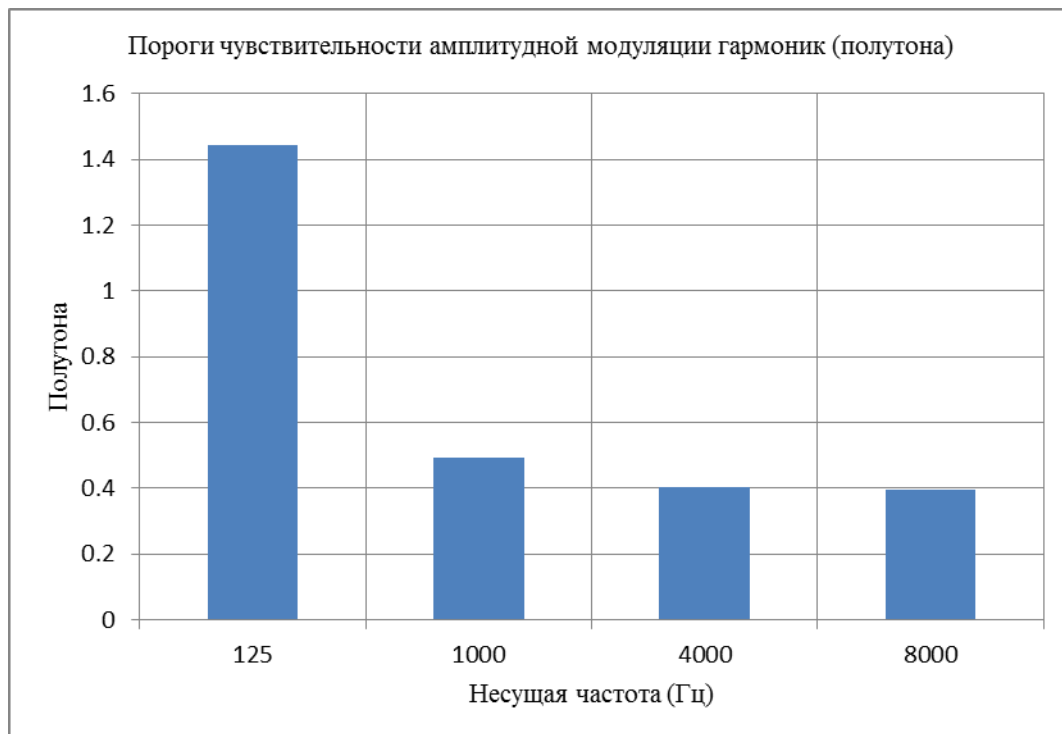
Рис. 5 Средние значения порогов чувствительности слуха к степени частотной модуляции гармонических сигналов.
