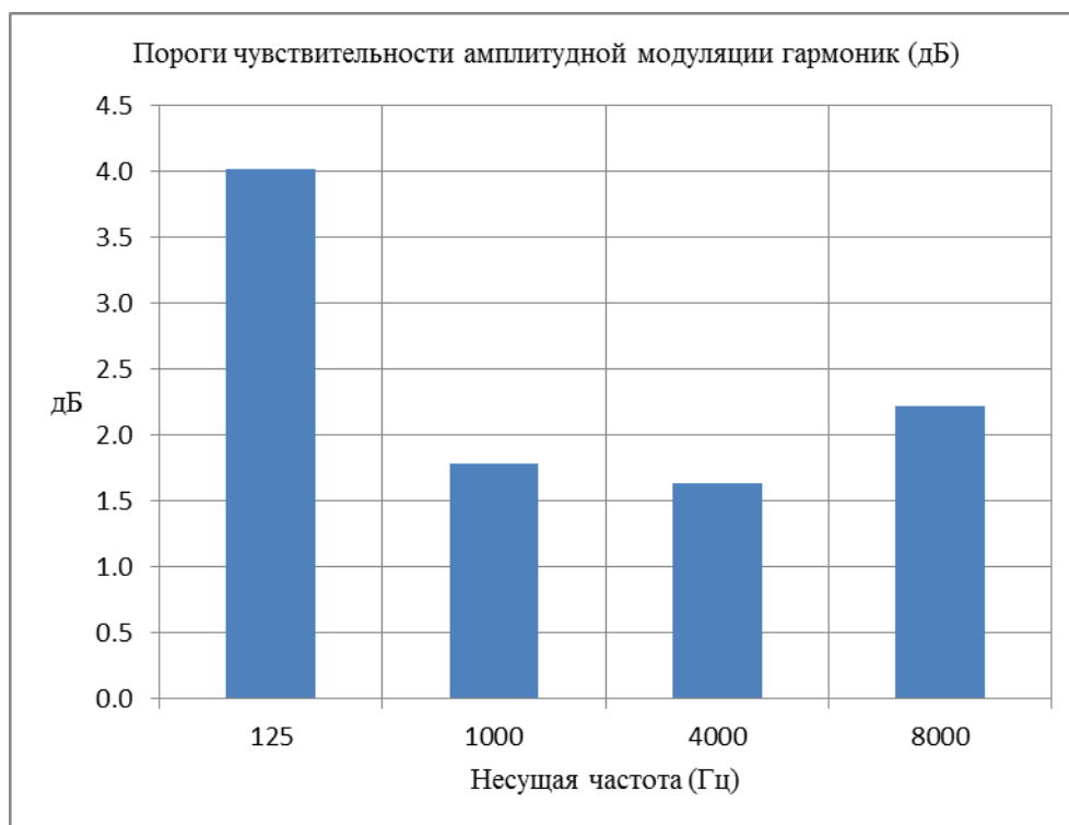
Рис. 4. Средние значения порогов чувствительности слуха к степени амплитудной модуляции гармонических сигналов.
